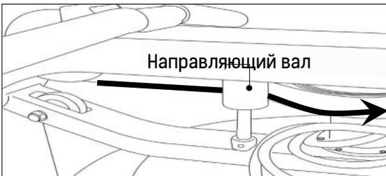
Далее, пропустите ремень вокруг направляющего вала в точности как на рисунке и закрепите на основном валу с помощью липучки. На валу вы найдете специальную выемку для установки конца ремня.
